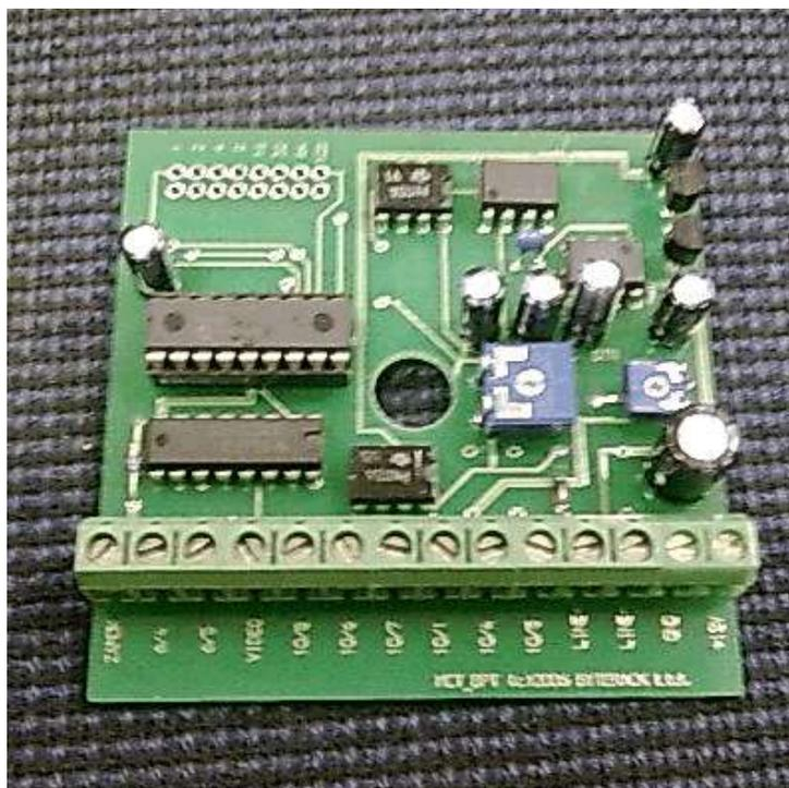
Модуль МСТ-02.002 ВРТ предназначен для сопряжения в единый комплекс подъездного аудиодомофона с координатной линией абонентских трубок (типа ВИЗИТ) с индивидуальным видеодомофоном ВРТ.
