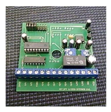
Модуль МСТ-01.002 ВРТ предназначен для сопряжения в единый комплекс подъездного аудиодомофона с двухпроводной линией абонентских трубок (типа Raikman) с индивидуальным видеодомофоном ВРТ.
